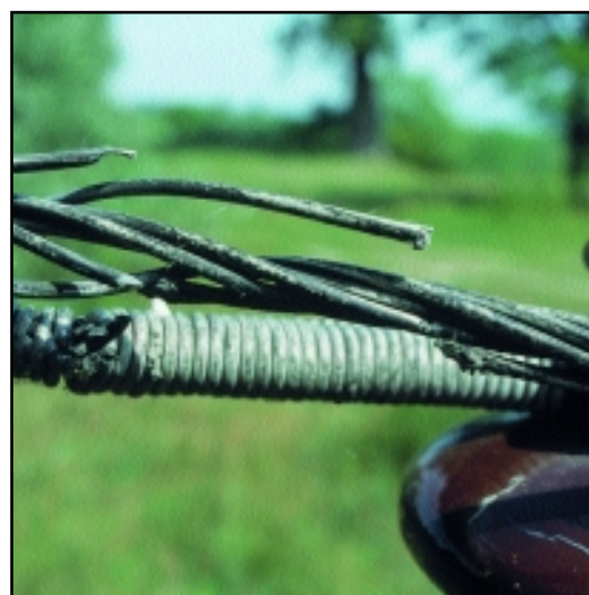
Gólyát ért áramütés következtében megolvadt vezeték
