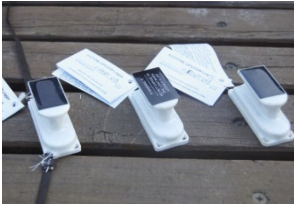
A vizsgálathoz használt Ecotone DUCK4 típusú jeladók / GPS/GSM data loggers used in the study, type Ecotone DUCK4
